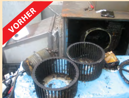
Der ehemals hochgradig verschmutzte Motor...
